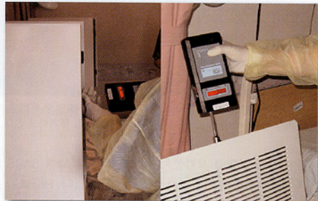
EMSD 전문가가 Laser Particle Counter를 가지고 각각의 공기청정기에 대한 정확한 여과효율을 측정하고 있다. 그 결과 대부분의 공기청정기가 효율테스트를 통과하지 못했다.
